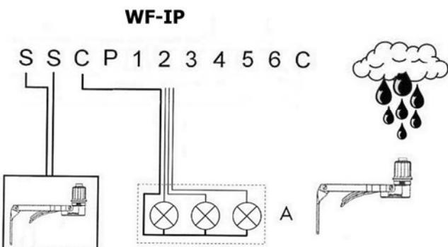
Čidlo srážek se zapojením
