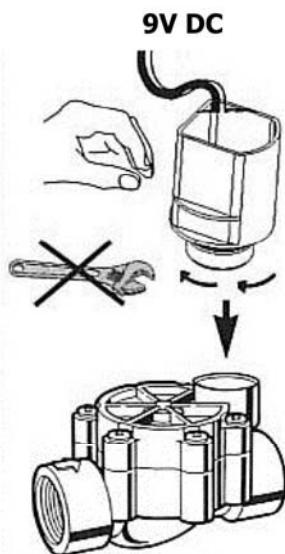
Ovládací modul WF-IP používejte **pouze s elektroventily s 9DC solenoidy.**
