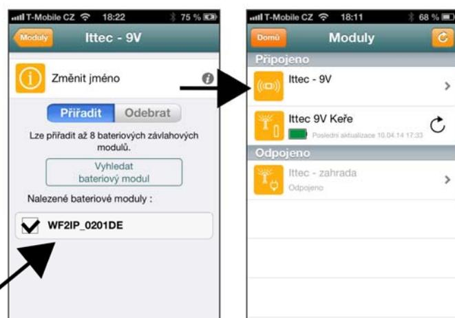
Vyčkejte cca 1 minutu a dostupné bateriové moduly se objeví na seznamu. Označte moduly které chcete spárovat (přiřadit) a klikněte na Přiřadit.
