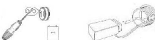
Odšroubujte víčko baterie na straně bateriového modulu, vytáhněte konektor baterie a oba výstupy konektoru zkrátujte pomocí kovového předmětu na cca 10 sekund. Poté připojte opět 9V baterii.
