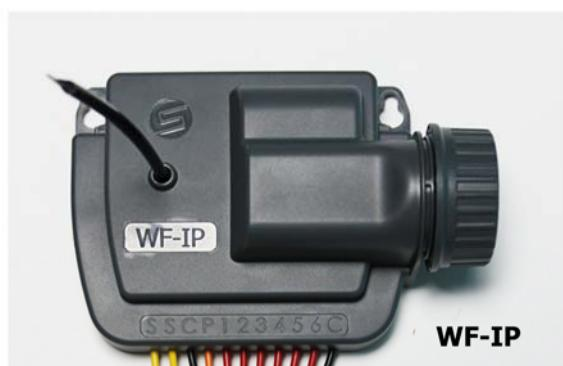
Kabelová smyčka pro připojení senzoru srážek. Pokud senzor není připojen, ponechte smyčku **nepřerušenou!**
