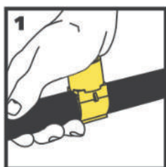
Nacvakněte na potrubí....
