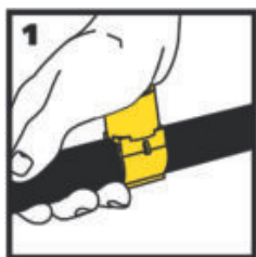
Nacvakněte na potrubí....
