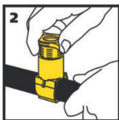
Adaptérem perforujete otvor do potrubí...
