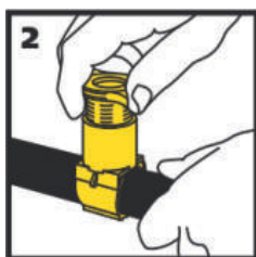
Adaptérem perforujete otvor do potrubí...
