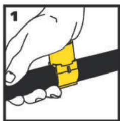
Nacvakněte na potrubí....
